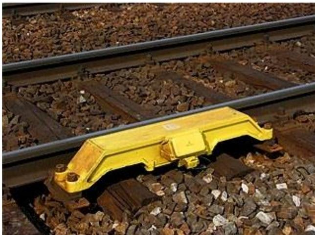
**Abbildung 11 PZB Gleismagnet**
