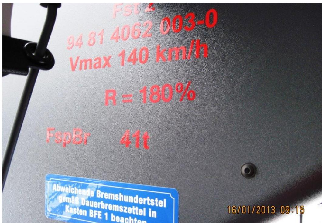
Abbildung 23 Bremsanschrift im Führerraum 2 des Twg BR 4062 (Quelle IM)
