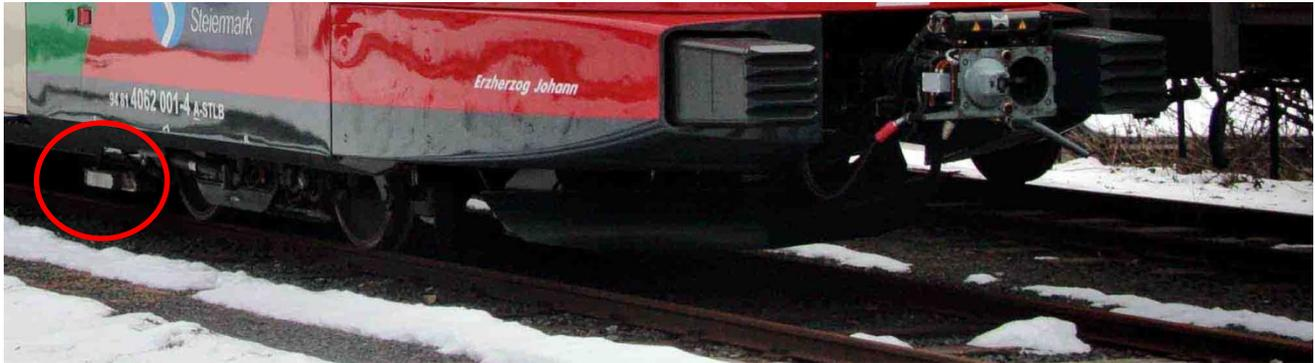
Abbildung 26 Anordnung PZB-Fahrzeug-Magnet am Twg BR 4062 (Quelle IM)
