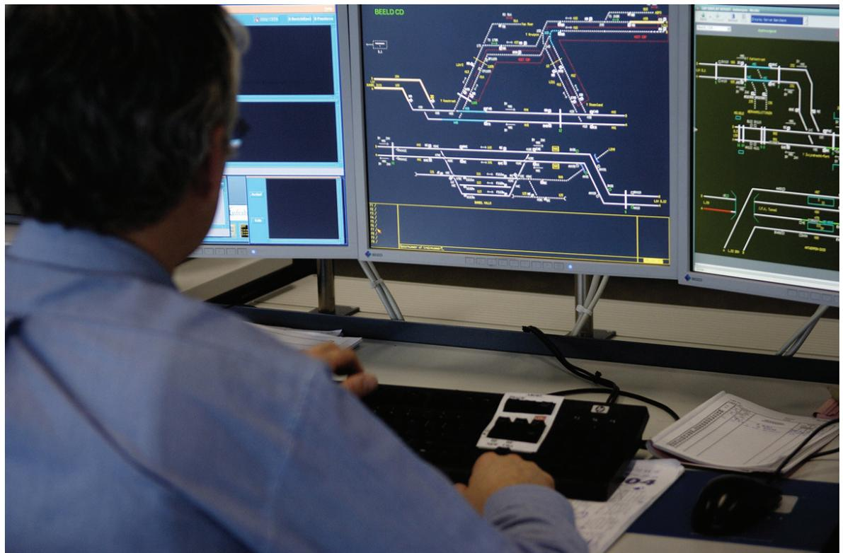
Une installation EBP fonctionne grâce à un logiciel générique EBP (logiciel développé et maintenu par Siemens), auquel est appliqué un fichier de configuration reprenant les spécificités des installations contrôlées par le poste de signalisation.
