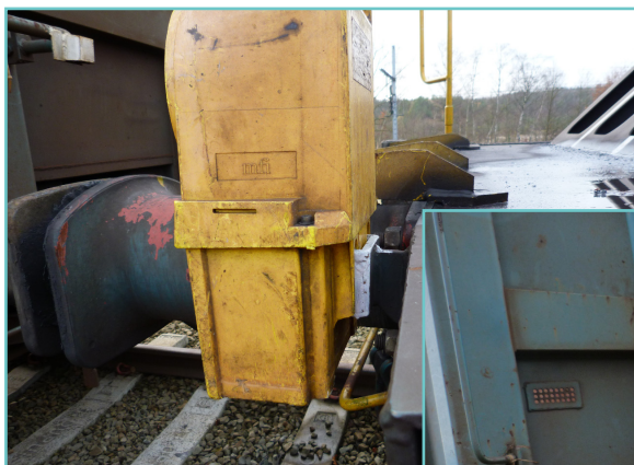
Lanterne enfoncée correctement dans le support ("étrier" blanc)
