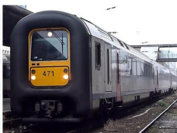
Les AM96 sont des automotrices électriques composées de 3 caisses (ou voitures) de 26.4 m chacune.
