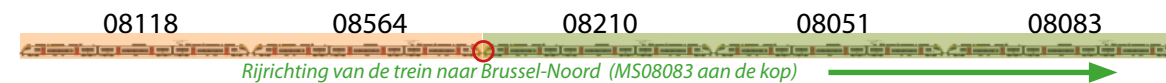
Afbeelding van de twee gekoppelde treinen (met de beschadigde stellingen achteraan in de zin van de rijrichting).
