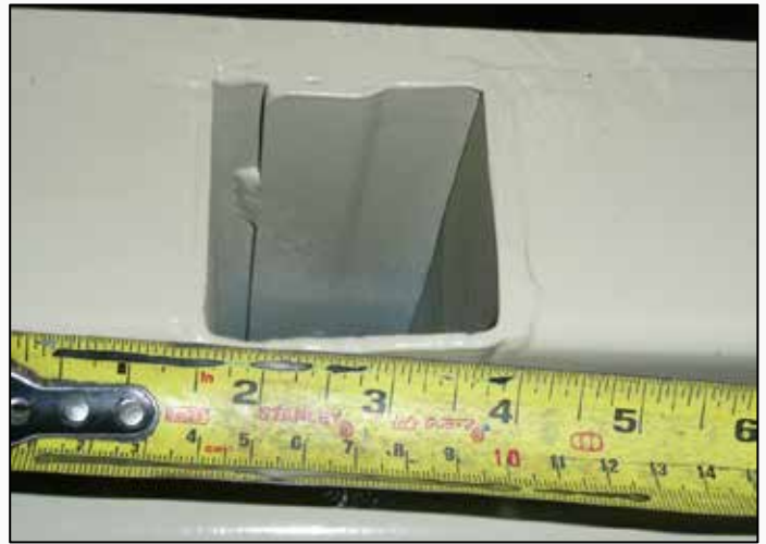
Photo 10. Tubulure utilisée pour l'ossature du toit. Revêtement du toit dans le haut de la photo (source : BST).
