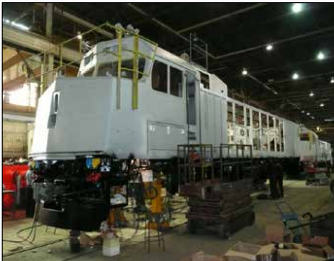
Photo 7. Locomotive F40PH-2D GM de VIA après son démontage (source : BST)
