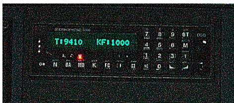
Betjeningspanel til S-baneradio i førerrum i litra SA
