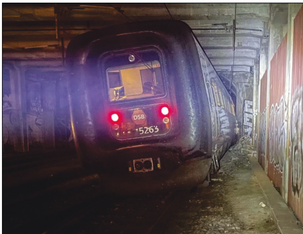
Foto 1: Bagenden af MF 5063 afsporet med to bogier.
