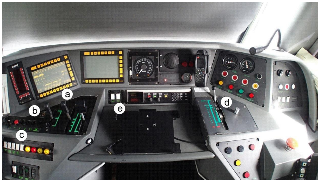
Kuva 9. Kuvassa Sm4-junan ajopöytä hallintalaitteineen: a) monitori b) virtalukko c) ajopöydän kytkimet (vasemmalta ohjauspiirit, PK kiinni, PK auki, takimmainen virroin, etummainen virroin, apukäyttöinvertteri ja kompressorin pakkokäyttö), d) jarrukahva ja e) valonheittimen kytkin.
