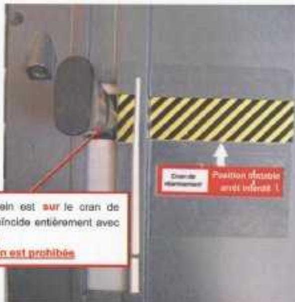
Le manipulateur de frein est **sur** le cran de réarmement lorsqu'il coïncide entièrement avec la bande jaune et noire.
