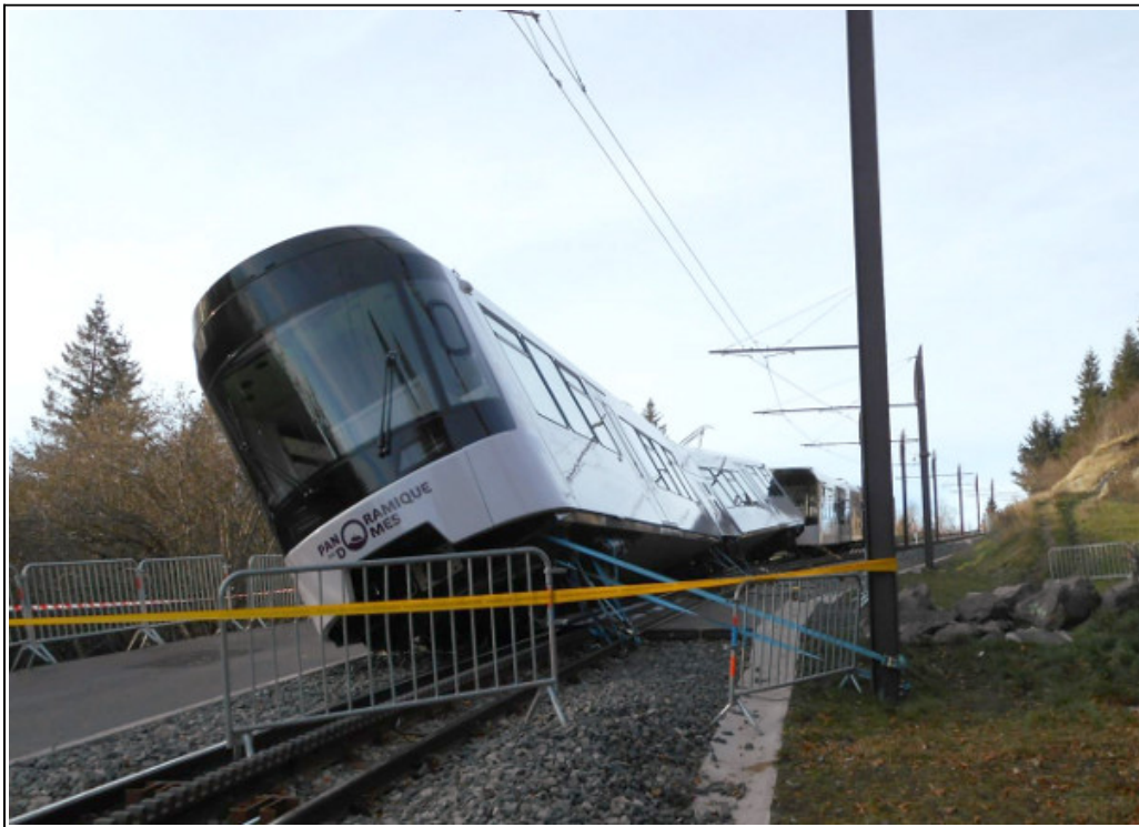
Figure 7 : La rame déraillée vue de face
