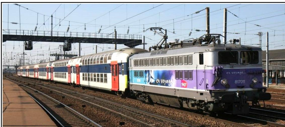
Figure 8 : Une locomotive BB 17000 en tête d'une rame de voitures VB2N
