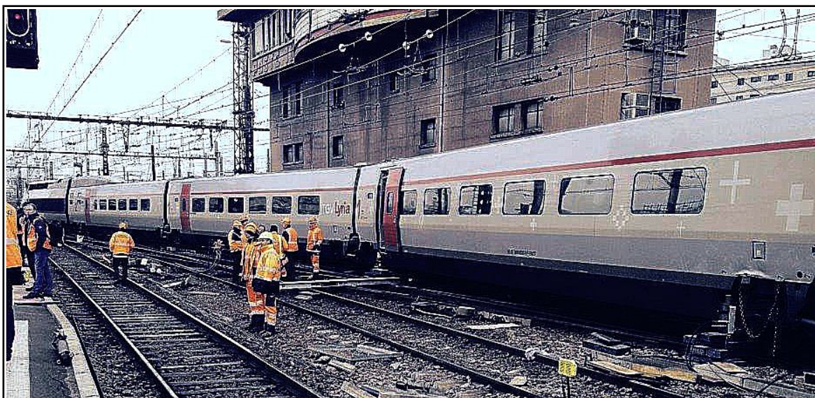
2- La rame n° 4402 sur l'aiguille 22L au pied du Poste 2 après le déraillement
