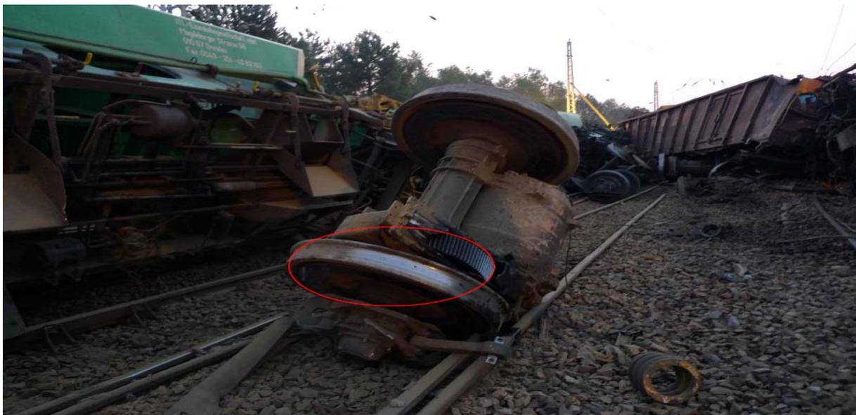
Abb. 13: Flachstelle auf einer Radlauffläche des Triebfahrzeugs
