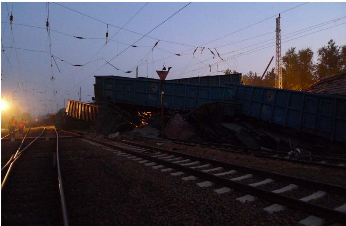
Abb. 2: Im Bereich der Kollisionsstelle aufgetürmte Güterwagen
