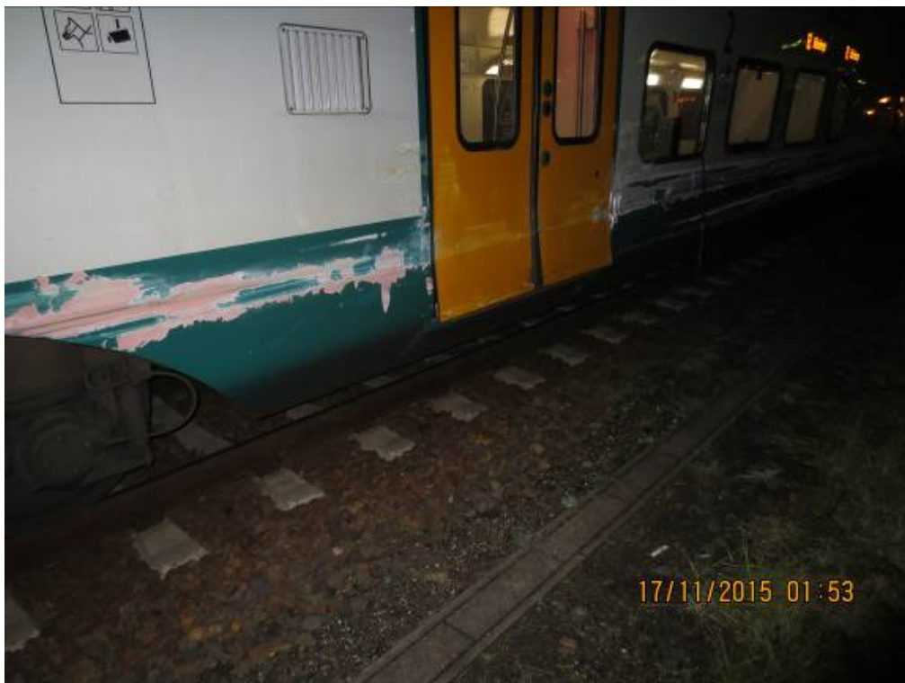
Abb. 4: Beschädigter Triebzug ET 445 109, außen
