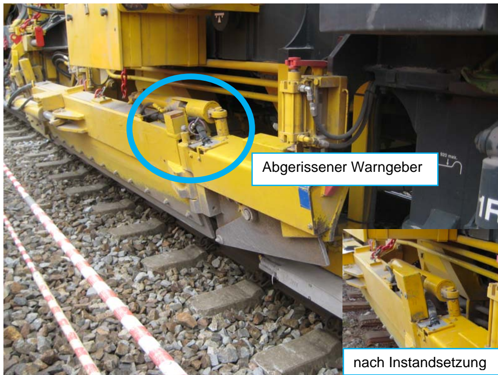
Abb. 8: Warngerät am rechten Flankenpflug der Schotterplaniermaschine 9980 9125 006-3 Quelle: DB Netz AG, Detailbild EUB
