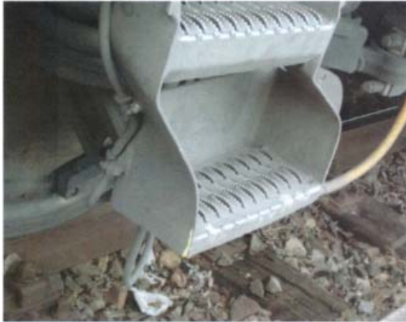
Abb. 6: verbogene Trittstufe im Detail Quelle: Die Länderbahn GmbH
