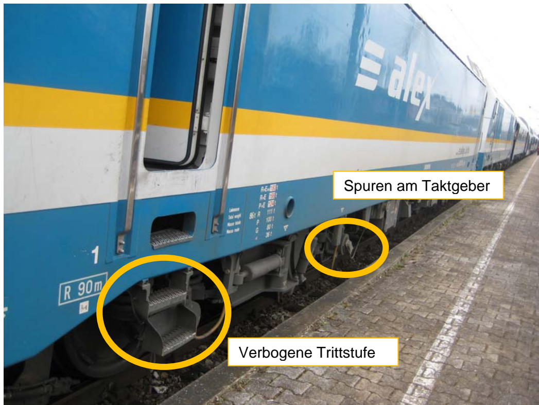
Abb. 5: Lok 9180 6183 002-5 mit Markierung der Schadensspuren Quelle: DB Netz AG
