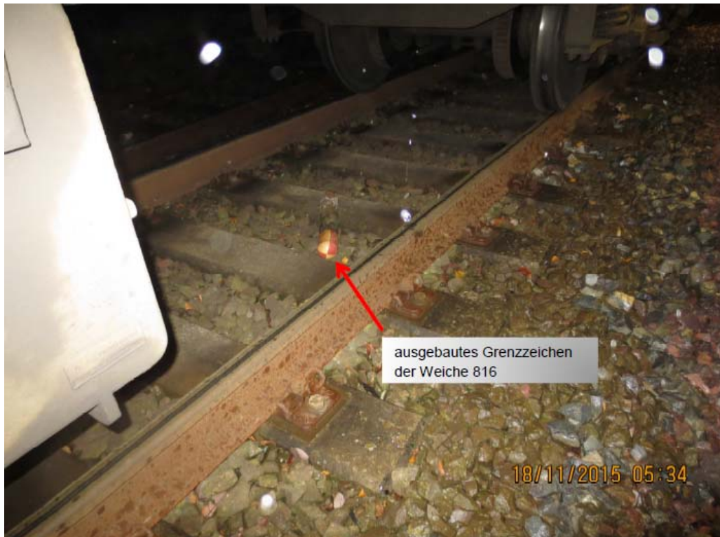
Abb. 6: Lage des So 12 der Weiche 816 im Gleis 802
