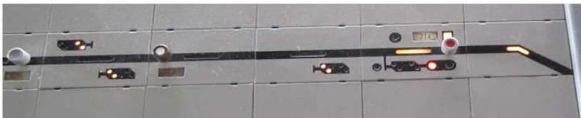
der Blockabschnitt wird aber nicht bis zum Esig A 200 des Bf MKMR ausgeleuchtet, sondern nur bis Höhe des Zbk 314 (=Zbk der Gegenrichtung), also fehlerhafte (da unvollständig) Stellischanzeige des Blockabschnittes Zbk 313 – Bf MKMR.
