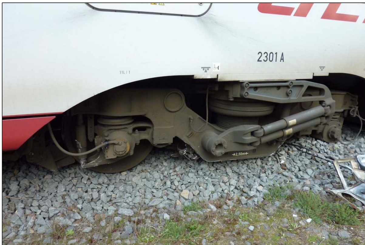
Abbildung 13: entgleistes Drehgestell RE-D 5106
