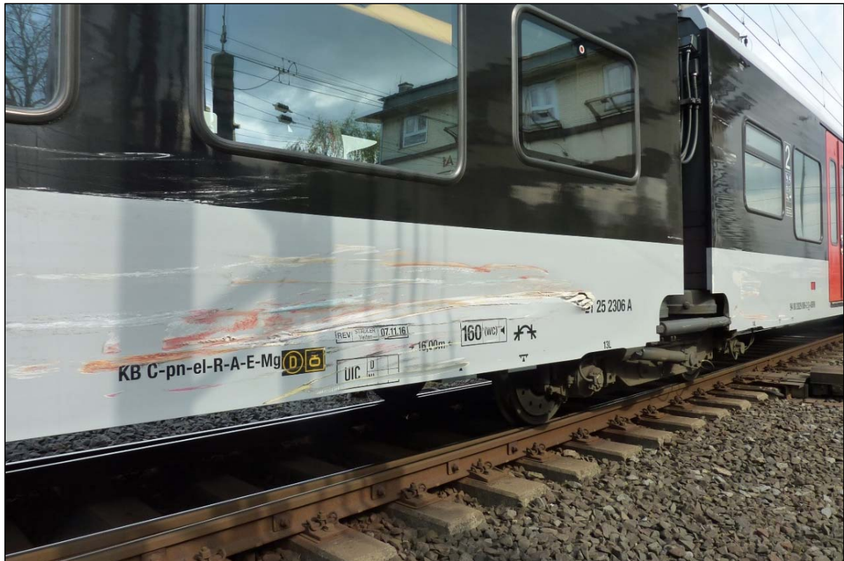
Abbildung 12: Beschädigungen am DLR 92365
