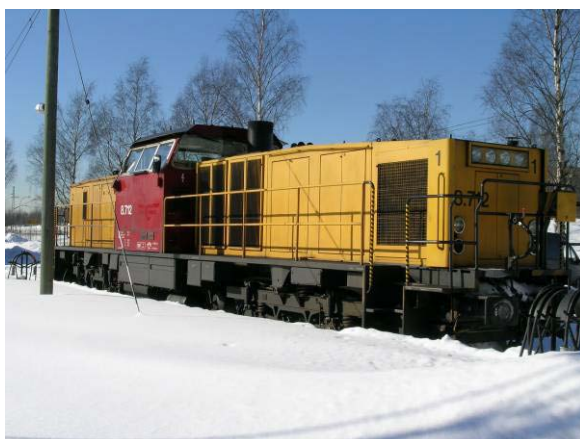
Figur 12: Viser et DI8-lokomotiv, og eksosanlegget som dekker noe av sikten fra førerrommet ved kjøring fra ende 1.
