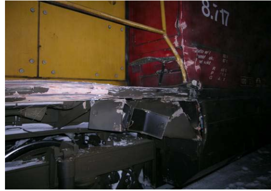
Figur 5: Skadene på det fremre lokomotivet i godstoget.
