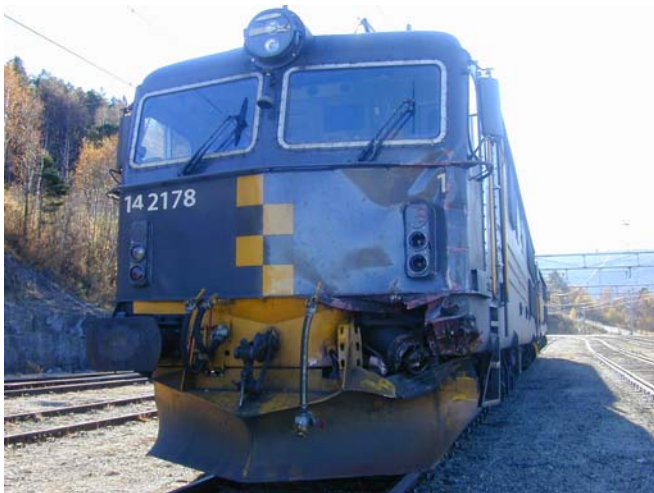
Skadene i front på El 14.2178, tog 5701
