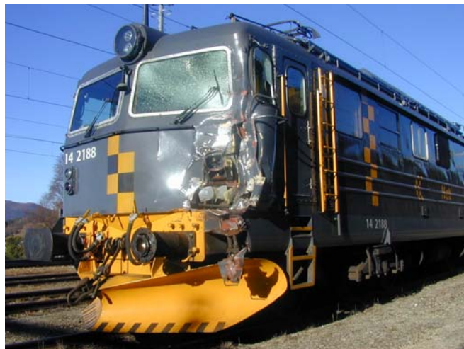
Skadene i front på El 14.2188, tog 5708
