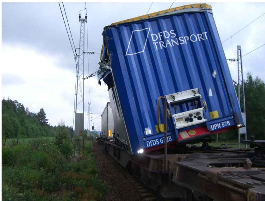
Figur 1: Viser den skadde semihengeren som var utenfor profil.
