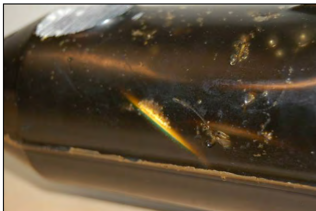
Figur 5: Utsnitt fra figur 4 viser ledere som ligger helt i ytterkanten av kabelmuffen.
