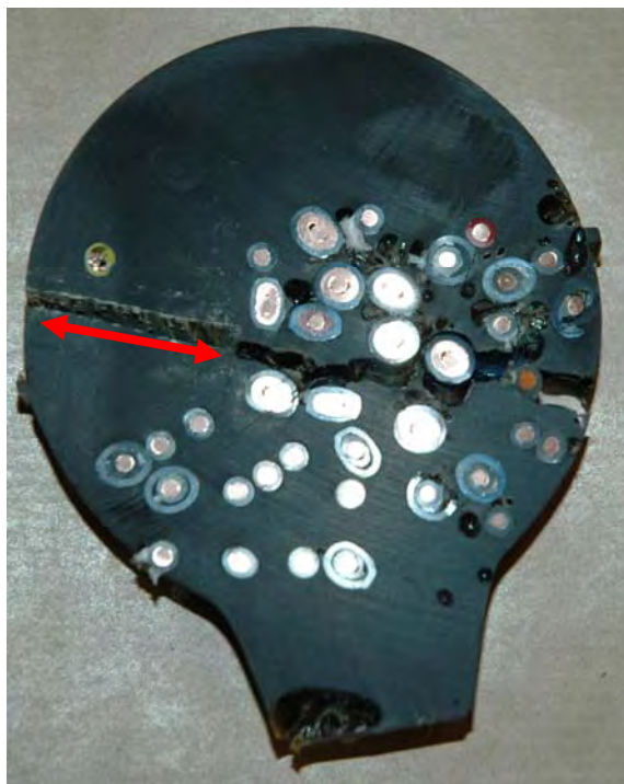
Figur 5 Oversiktsbilde av snitt nummer 10 i Figur 2 etter oppbryting. Rød pil angir snitt benyttet som bruddanviser.
