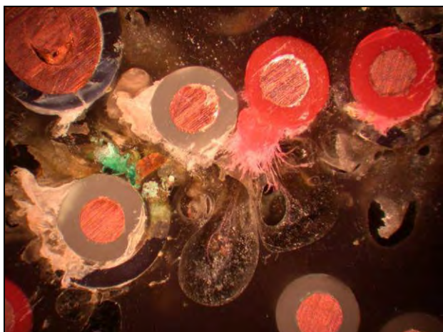
Figur 8: Viser at det finnes luftbobler i muffen, og at det er tydelig irrdannelse mellom ledere.
