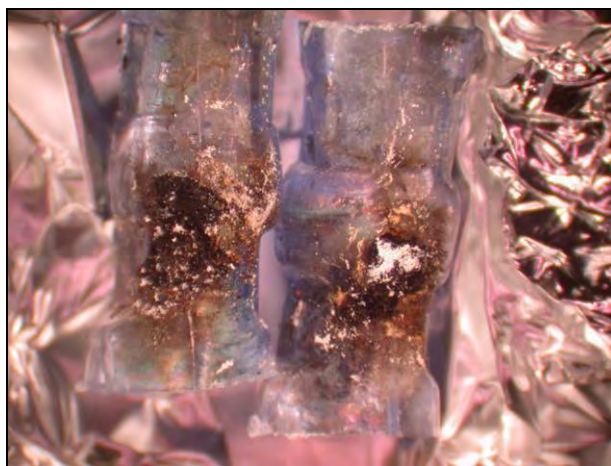
Figur 9: Viser detaljer av to skjøtehylser med tydelige brennmerker.
