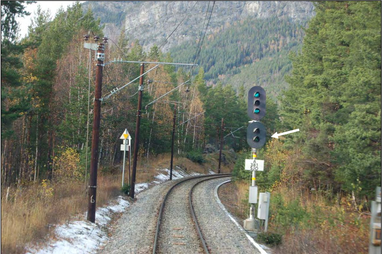
Figur 3: Innkjørhovedsignal A. (Pilen viser til forsignal L/N som viste galt signalbilde.)
