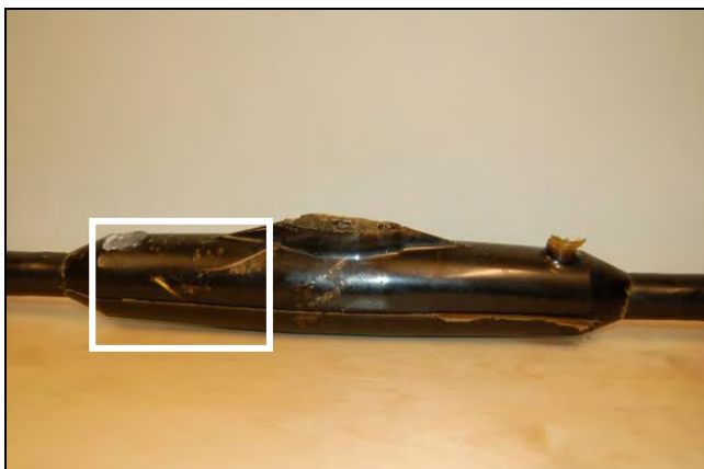
Figur 4: Viser kabelmuffen etter at skallet er fjernet. Utsnitt vises i figur 5.
