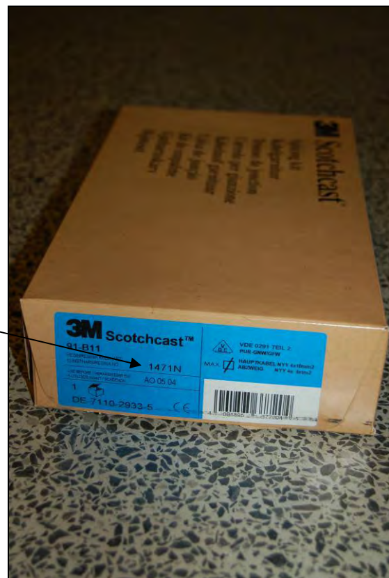
Figur 11: Viser datomerking på esken til skjøtemuffen.
