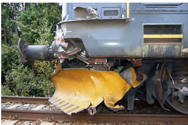
Figur 3: Skader på front av lokomotiv i tog 5722
