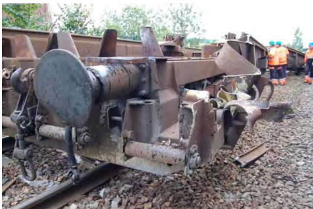
Figur 1: Skader i front venstre side på vogn 4076 943 1033-2
