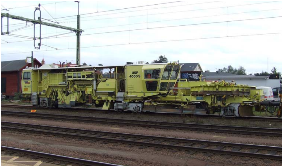
Fig 4. Banverkets ballastplog PLB 2469.
