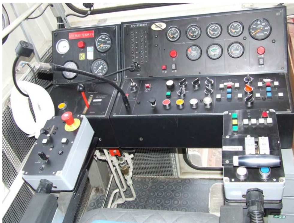
Fig 9. Förarplatsen varifrån ballastplogen kördes. Det kombinerade fart- och bromsreglaget syns längst ner till höger.
