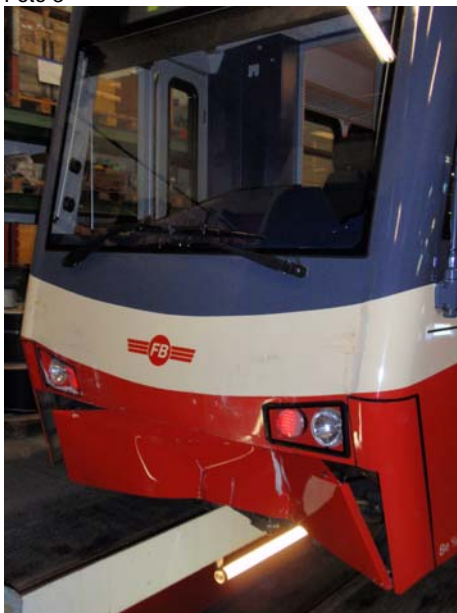
Schäden am Be 4/6 Nr. 73
