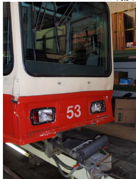
Schäden am Be 4/4 Nr. 53. Die Türe zum Führerstand lässt sich nur noch mit Mühe öffnen.
