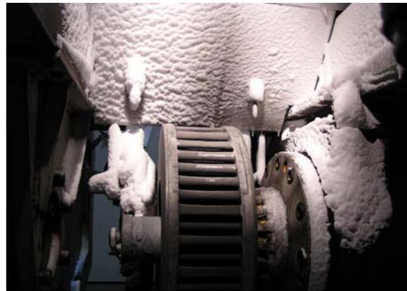
Das Innere des Prüfstandes der Firma BECORIT. Erkennbar sind die Aluminium-Bremsscheibe und die Bremsbeläge mit dem Bremsgestänge.
