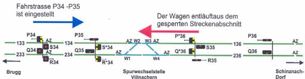
Kurz vor dem Zusammenstoss fuhr ein Zug auf dem Regelgleis talwärts, der Spurwechsel war dadurch in gerader Stellung.
