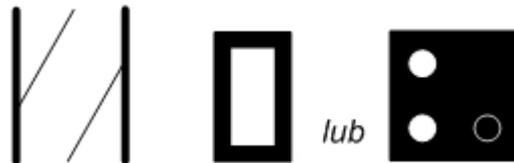
„Die Weiche ist in gerader Richtung gestellt bzw. bei einseitigen Bogenweichen in Richtung zum Gleisbogen mit dem größeren Radius für die Fahrt in Richtung Spitze oder entgegen der Spitze
