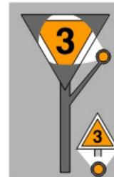
15. Signal D6 „Geschwindigkeit verringern“ bedeutet, im Bremswegabstand befindet sich ein Gleisabschnitt, der mit einer geringeren, als der im Fahrplan vorgesehenen Geschwindigkeit, befahren werden darf. Wurde der Triebfahrzeugführer vorher nicht benachrichtigt, mit welcher Geschwindigkeit über die mit dem Signal D6 gedeckte Stelle gefahren werden darf, und ist diese Geschwindigkeit nicht auf der Scheibe angezeigt, muss die Geschwindigkeit auf 20 km/h abgesenkt werden.
