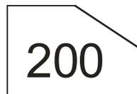
Das sonstige Signal W 32 kommt auf Bahnhöfen und Haltepunkten des Personenverkehrs zur Anwendung; das sonstige Signal W 32, bei Bedarf mehr als eins, für Züge unterschiedlicher Länge, wird in Abhängigkeit von den örtlichen Bedingungen so angebracht, dass eine möglichst bequeme Abfertigung der Reisenden erfolgen kann.
