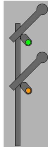
Das Signal Sr 3 erlaubt die Fahrt mit einer Geschwindigkeit von höchstens 40 km/h, beginnend am Hauptsignal bis zum Ende des durch das Hauptsignal gedeckten Weichenbereiches. Im Falle eines Einfahr- oder Zwischensignals gilt die Geschwindigkeit mit höchstens 40 km/h auf dem ganzen Fahrweg.
