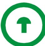
Das Zeichen weist auf die Stelle, an der die Bedieneinrichtung für das Lichtsignal Zp 9 aufgestellt oder angebracht ist.
