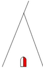
Der Standort des sonstigen Signals wird unter Berücksichtigung des geltenden Lichtraumprofils und örtlicher Verhältnisse festgelegt, (...).
