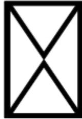
Das sonstige Signal W1 bezeichnet den Standort des Vorsignals des Hauptsignals oder der Signale vor Bahnübergängen sowie auf Strecken mit vierbegriffigem automatischem Streckenblock, den Standort des vorletzten Blocksignals vor dem Einfahrsignal einer Strecke des selbsttätigen Streckenblocks.
