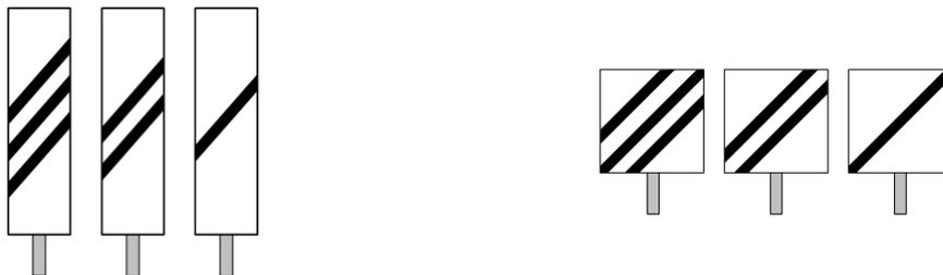
b) Vorsignal des Einfahrhauptsignals einer Betriebsstelle, an der ein elektrifizierter Streckenabschnitt beginnt (sonstiges Signal W 11b).
