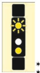
869. Das Signal **Geschwindigkeit 40 km/h und Wiederholung des Signals Geschwindigkeit 40 km/h erwarten** (*gelbes Licht, darüber ein weißes Licht und über dem weißen Licht ein langsam blinkendes gelbes Licht*) gestattet die Fahrt des Zuges, weist den Triebfahrzeugführer an, bis zur folgenden in unzureichendem Bremswegabstand aufgestellten Hauptsignaleinrichtung mit höchstens 40 km/h zu fahren und kündigt die Geschwindigkeit 40 km/h oder 30 km/h ab dieser Signaleinrichtung an.
