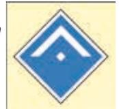
Befindet sich dieses Signal an einer einfachen Weiche, weist es auf ein Gleis ohne Fahrleitung für die gerade Fahrtrichtung über die Weiche hin.
