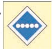
3455. Ist ein Anzeiger mit dem Signal **Bügel ab** um ein Mastschild mit blauen und weißen Streifen gleicher Länge ergänzt, gilt er nur für Rangierarbeiten. Ein Verzeichnis dieser Anzeiger muss in Tabelle 3 der Tabelle der Streckenverhältnisse und in der ZDD (Grundlegende Betriebsdokumentation) aufgeführt sein.
