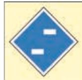
kündigt dem Triebfahrzeugführer eines elektrischen Triebfahrzeugs die Signale **Bügel ab, Gleis in gerader Richtung ohne Fahrleitung, Gleis in Richtung nach rechts ohne Fahrleitung** oder **Gleis in Richtung nach links ohne Fahrleitung** an.
