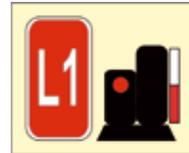
726. **Für Zugfahrt und Rangieren geltende Lichthauptsignaleinrichtungen** (ausgenommen Zwergsignaleinrichtungen) haben rote Kennzeichnungsschilder (ggf. mit weißem Rand) mit weißer Aufschrift und Mastanstrich oder Mastschilder mit roten und weißen Streifen, wobei die weißen kürzer sind als die roten.
