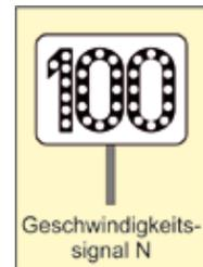
1337. Sind zwei Geschwindigkeitssignale N übereinander angebracht, gilt die durch das obere Geschwindigkeitssignal N signalisierte Geschwindigkeit für die Fahrt von Fahrzeugen, die in der Lage sind, einen Bogen bei einem wirkenden Überhöhungsfehlbetrag im Umfang bis 130 mm<sup>13</sup> zu durchfahren.
