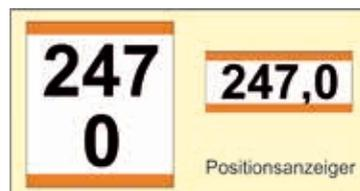
schwarzer Zahl, die die Kilometer- und die Hektometerposition anzeigt, die obere und untere Seite ergänzt um orangefarbene Streifen) informiert über die Position auf der Strecke und kennzeichnet einen Streckenabschnitt, in dem die Notbremsüberbrückung benutzt werden muss, wenn die Zuggarnitur damit ausgestattet ist.
