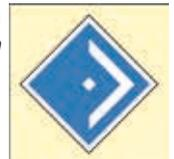
befahrbar ist, und weist den Triebfahrzeugführer eines elektrischen Triebfahrzeugs an, spätestens in Höhe dieses Signals mit abgesenktem Stromabnehmer zu fahren.
