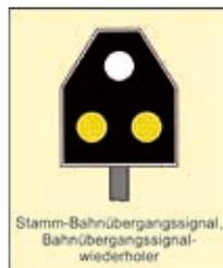
3512. Das Signal **Gesicherter Bahnübergang** (zwei gelbe Lichter oder zwei gelbe kreisförmige Reflektoren nebeneinander und über ihnen in der Mitte ein weißes Blinklicht, die zusammen ein gleichschenkliges Dreieck bilden) informiert über die korrekte Funktion der Sicherungsanlage. Außerdem weist dieses Signal den Triebfahrzeugführer an, dem Fahrdienstleiter zu melden, dass am Bahnübergangssignal ein weißes Blinklicht leuchtet.
