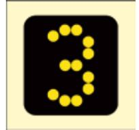
1361. Das Signal **Geschwindigkeit** (*leuchtende weiße Zahl mit dem Zehntelwert der Geschwindigkeit*) weist den Triebfahrzeug an, ab dieser Signaleinrichtung die mit dem Zehnfachen dieser Zahl angegebene Geschwindigkeit nicht zu überschreiten.
