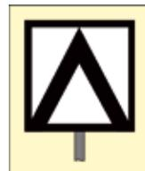
1237. Das Signal **Ende der Arbeit des Schiebetriebfahrzeugs** (*quadratische weiße Tafel mit schwarzem Rand und einem schwarzem, nach unten zeigendem Pfeil*) weist den Triebfahrzeugführer eines Schiebe- bzw. eines Zwischentriebfahrzeugs an, die Entwicklung von Antriebskraft einzustellen.
