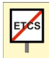
1210. Eine Signaleinrichtung mit dem Signal **Wechsel des ETCS-Levels** wird an der Stelle aufgestellt, an der der ETCS-Bereich beginnt oder an der das ETCS-Level wechselt und die selbsttätige Umschaltung auf das neue Level erfolgt. Sie wird in der Regel an einer Hauptsignaleinrichtung oder in deren unmittelbarer Nähe angebracht.
