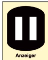
1483. Das Signal **Verkürzter Abstand** (*schwarze, auf der längeren Seite stehende Rechtecktafel mit zwei senkrechten weißen Streifen*) weist auf den verkürzten Abstand von der so gekennzeichneten Signaleinrichtung zur nächsten Signaleinrichtung hin.
