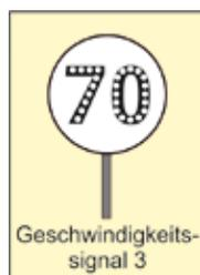
Die Beendigung der mit einem Geschwindigkeitssignal 3 angeordneten Geschwindigkeit legt ein Geschwindigkeitssignal N fest, das nicht mit einem Geschwindigkeitssignal 3 zusammensteht, oder ein weiteres Geschwindigkeitssignal 3.
