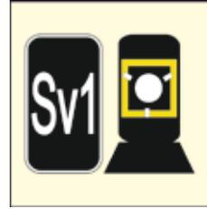
521. Für die Fahrtrichtung nach der Spitze geltende Signale an Signaleinrichtungen von Rückfallweichen sind mit einer gelben Umrandung versehen. Die so gekennzeichneten Signaleinrichtungen informieren über die Möglichkeit, diese Weichen nach der Spitze zu befahren, auch wenn sie nicht für die gewünschte Fahrt gestellt sind.
