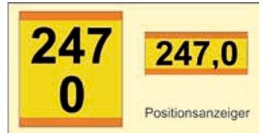
1170. In einem Streckenabschnitt, in dem die Notbremsüberbrückung benutzt werden muss, müssen alle Positionsschilder mit orangefarbenen Streifen versehen sein. Dieser Abschnitt wird mit dem ersten Positionsschilder ohne orangefarbene Streifen beendet.
