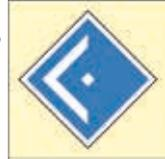
weist entweder darauf hin, dass in Fahrtrichtung nach links ein Gleis ohne Fahrleitung folgt oder dass der folgende Abschnitt der Fahrleitung nicht befahrbar ist, und weist den Triebfahrzeugführer eines elektrischen Triebfahrzeugs an, spätestens in Höhe dieses Signals mit abgesenktem Stromabnehmer zu fahren.
