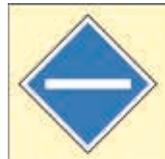
3416. Das Signal **Bügel an** (quadratische, auf der Spitze stehende blaue Tafel mit weißem Rand, darin ein senkrechter weißer Streifen in der Diagonale; ist die Signaleinrichtung nicht aus reflektierendem Material, ist der Streifen aus weißen Reflektoren) gestattet dem Triebfahrzeugführer die Fahrt mit angelegtem Stromabnehmer, wenn das elektrische Triebfahrzeug dieses Signal passiert hat.
