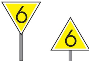
Die gezeigte Kennziffer bedeutet, dass der 10fache Wert in km/h als Fahrgeschwindigkeit vom Signal Lf 7 ab zugelassen ist.
