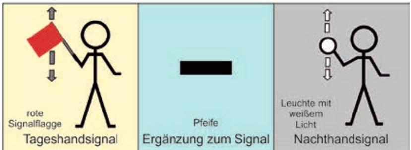
1614. Das Signal **Herkommen** (*waagerechte lange Bewegungen mit roter Signalfolge [Tagessignal] oder mit Handleuchte mit weißem Licht [Nachtsignal]; bei Bedarf ergänzt um zwei lange Töne mit der Pfeife*) weist die Bewegung der Fahrzeuge in Richtung zum Signalgeber hin an.
