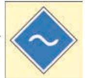
3419. Das Signal **Beginn des Einphasenstromsystems** (quadratische, auf der Spitze stehende blaue Tafel mit weißem Rand, darin eine weiße Sinuskurve, symmetrisch auf der waagerechten Diagonale angeordnet, darüber die weiße Zahl „15“) weist den Triebfahrzeugführer eines elektrischen Triebfahrzeugs an, das Triebfahrzeug eines anderen Systems als des Wechselstromsystems mit 15 kV, 16,7 Hz außer Betrieb zu nehmen, bei einem Mehrsystemtriebfahrzeug in das entsprechende Bahnstromsystem umzuschalten.
