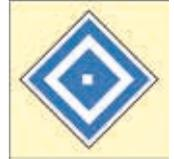
Befindet sich dieses Signal an einer Weiche, weist es auf Gleise ohne Fahrleitung für alle Fahrrichtungen über die Weiche hin.
