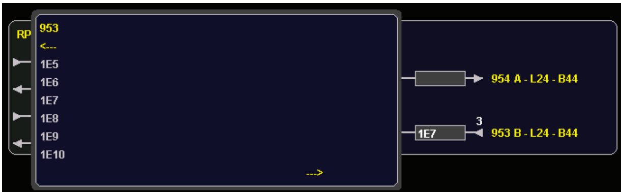
Abbildung 6 : Anzeige aller Zugnummern auf einem Gleis im ESTW Bereich
