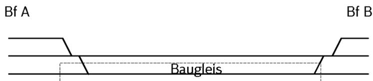
b) Baugleis wird in eine Zugmeldestelle fortgeführt
